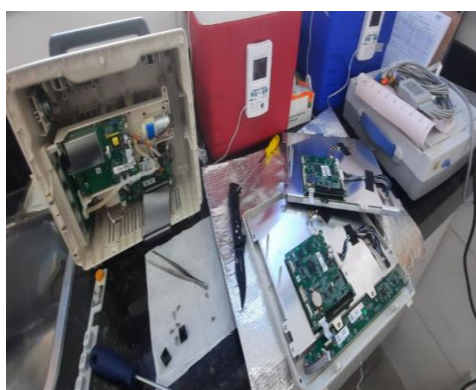
7-Manutenção corretiva de monitor
