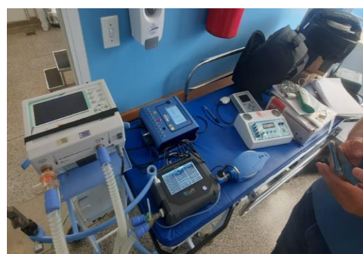
3-Calibração ventilador de transporte
